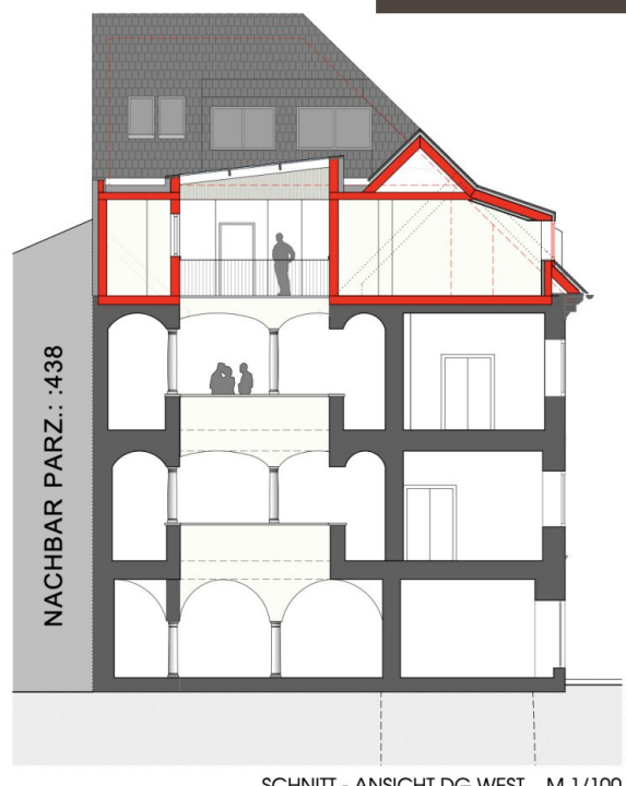
SCHNITT - ANSICHT DG WEST M 1/100
